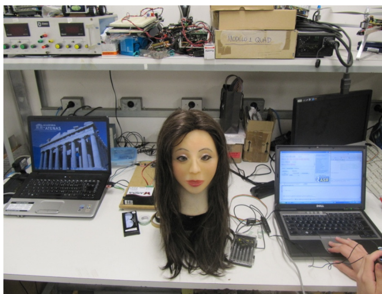
Figura 62- Montagem completa do sistema (computador com TTS a esq. e com ASR a dir.)
